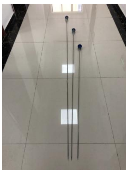
图 1 机械式听音杆图
